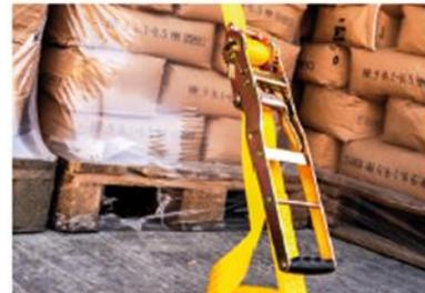
Geeignete Spannratschen (Vorspannung 500 daN)
