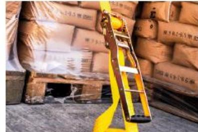
Geeignete Spannratschen (Vorspannung 500 daN)
